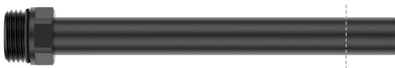
2. Обрезать трубку строго под прямым углом на необходимую длину при помощи трубореза и удалить заусенцы.
