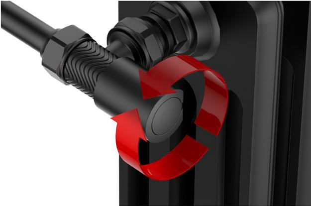
4.2. Настраечный вентиль регулируется монтажным ключом (арт. 901000). При отсутствии специального монтажного ключа можно использовать ключ для внутреннего шестигранника S6 (ГОСТ 11737), а также отвёртку, для которой предусмотрена шлицевая проточка на штоке:
