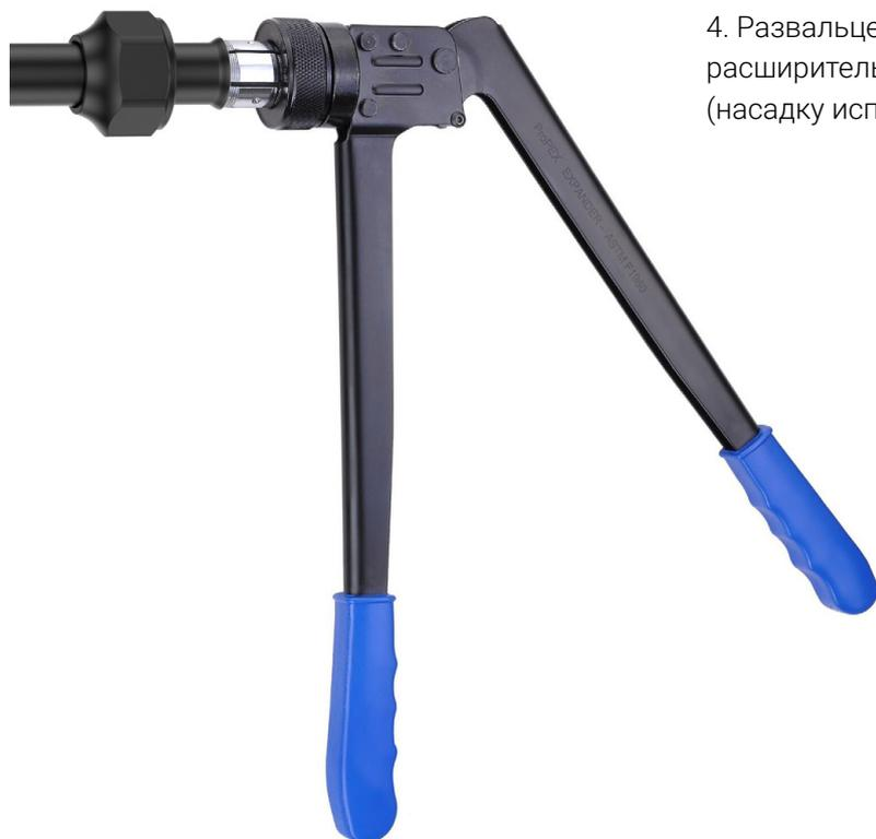
4. Развальцевать трубку при помощи расширительного инструмента (насадку использовать 15x1)
